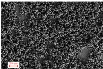
Image de nanoparticules organiques obtenues par microscopie électronique à balayage.
