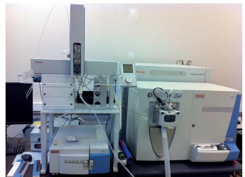
Plate-forme analytique : Couplage chromatographie en phase liquide-spectrométrie de masse haute résolution.
