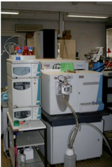
LC ESI ou DESI/LTQ Orbitrap Thermo Scientific, à gauche et ESI/FT-ICR 7T Apex Bruker à droite, deux appareillages à haute résolution parmi les huit instruments existants.
